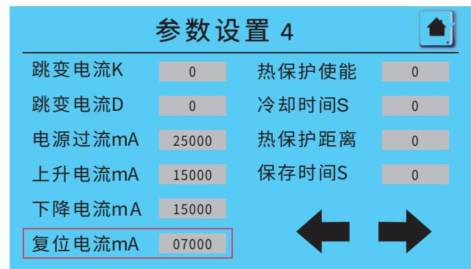
(请注意，如果升降系统的执行器为ANT-38, 复位电流的最大值应为4500,不能超过4500;如果升降的执行器为ANT-52，电机下降过流的最大值应为10000 , 不能超过10000)。
