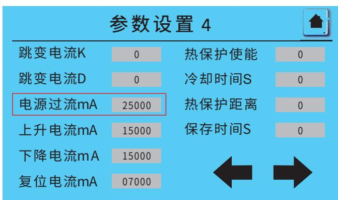
(请注意，如果升降系统的执行器为ANT-38, 同时整套升降系统包含两个ANT-38,电源过流的最大值应为9000,不能超过9000; 如果升降系统的执行器为ANT-38,同时整套升降系统包含四个ANT-38,电源过流的最大值应为18000, 不能超过18000 ;如果升降的执行器为ANT-52, 同时整套升降系统包含两个ANT-52,电源过流的最大值应为 20000, 不能超过 20000; 如果升降的执行器为ANT-52, 同时整套升降系统包含四个ANT-52, 电源过流的最大值应为40000,不能超过40000)。
