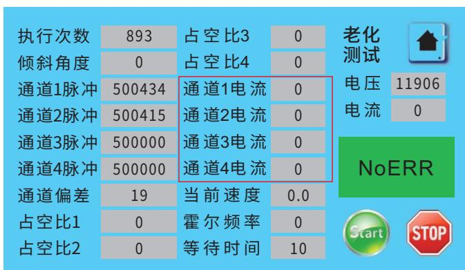
2.4 进入参数设置4页面，找到电机下降过流选项，将步骤2.3记录下来的最大数值加2000之后，输入到电机下降过流选项中。
